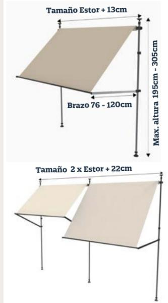
Un marco flexible y una persiana enrollable resultan en un toldo de balcón en un abrir y cerrar de ojos. El bastidor Flex consta de dos postes con un brazo intermedio que deben sujetarse entre el suelo y el techo. Con un solo acoplamiento se pueden montar varios bastidores flexibles uno al lado del otro.
