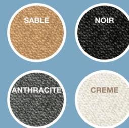
Le tissu Coolfit® est un tissu HDPE de 285 g/m<sup>2</sup>. Le tissu a une tresse aérée et il est donc perméable à l'eau et à l'air.
